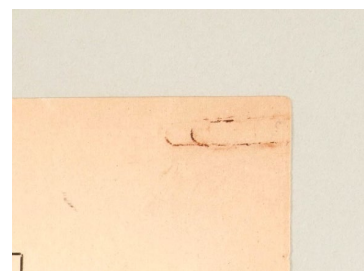
「131」汚れの付着 （クリップの錆）
