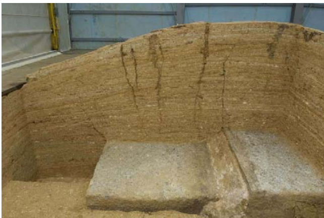
5 白色版築層南北断面の亀裂（天井石3・4）
