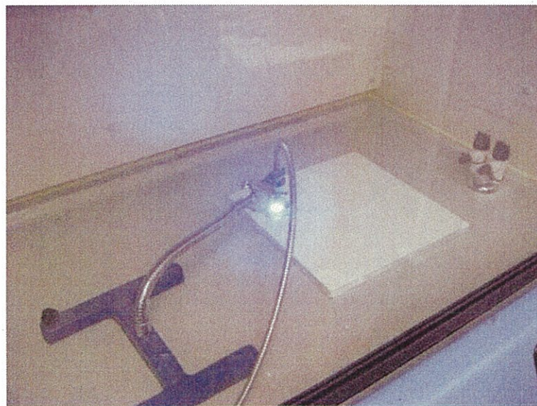
写真1 紫外線照射装置による漆喰サンプルへの照射
