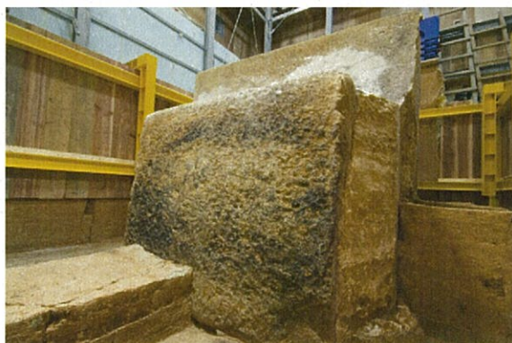
図27 北壁石外面で確認されたカビを含む黒色の汚れ（北壁石北側面）
