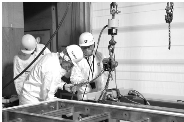
図 5.2 チェンブロックなど機材の目視点検作業
