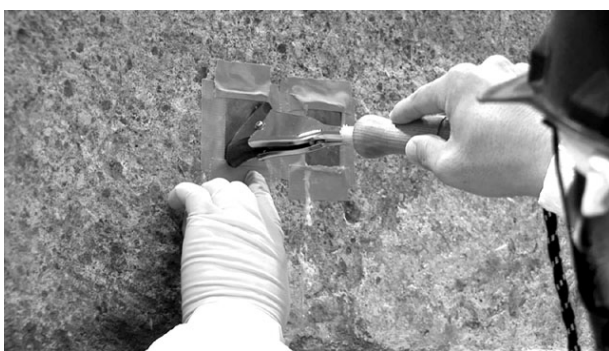
図 4.3 石材へのAEセンサー等の設置
