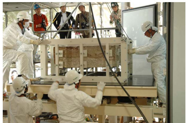
図 19 設置台上での位置・方向の修正
