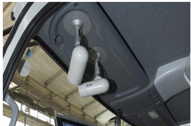
図5 助手席の CCD カメラ
