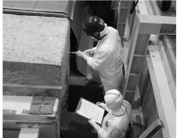
図 3.4 天井石 3 の針貫入試験
