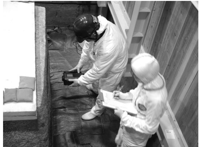
図②-1 赤外水分計による含水比の測定
