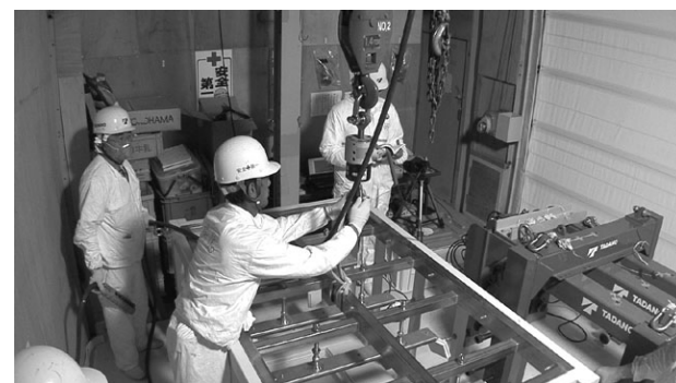
図 4.4 梱包材料の重量測定（ロードセル）
