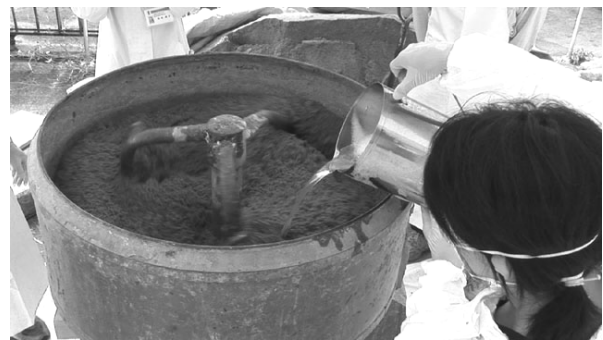
図 2.2. ミキサーを用いた砂の防黴処理
