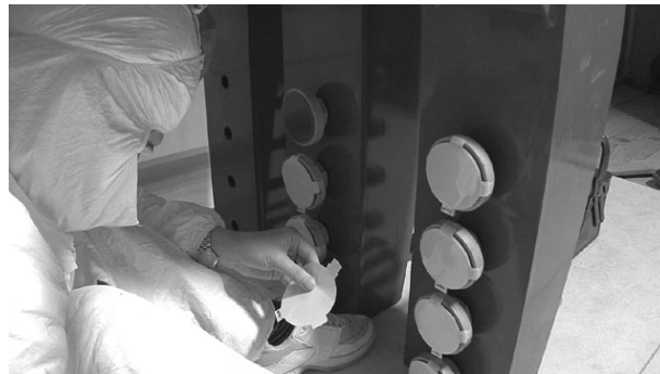
図 4.6 プレスケールを用いた接触状況調査
