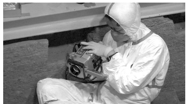
図⑬-3 石材の温度分布測定
