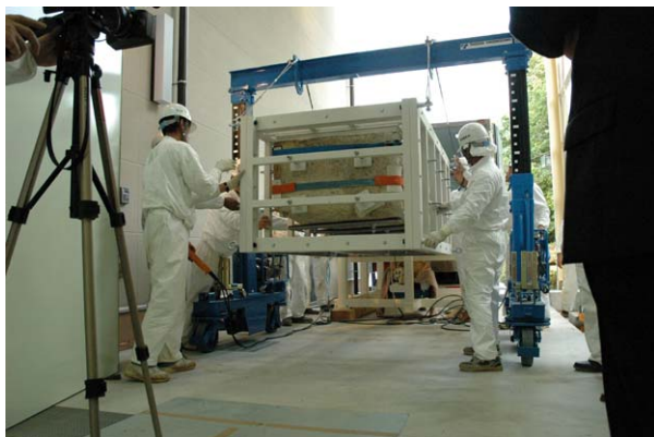
図 30 門形リフターによる吊り上げ・移動
