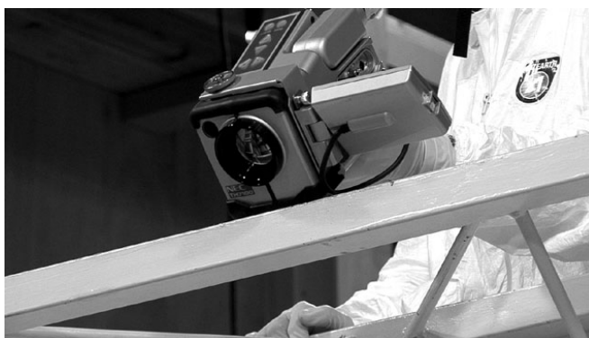
図 3.7 サーモグラフィによる石材表面温度測定
