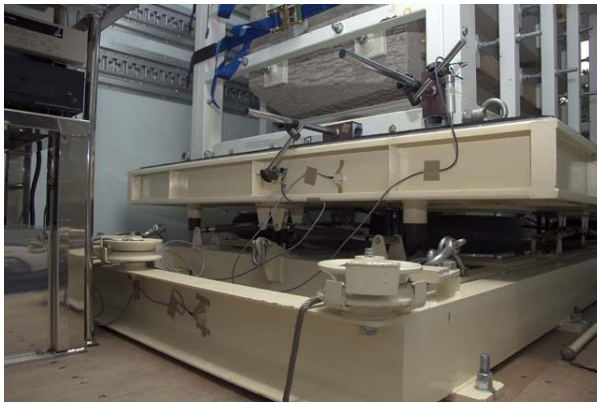
図7 加速度センサーと変位センサー
