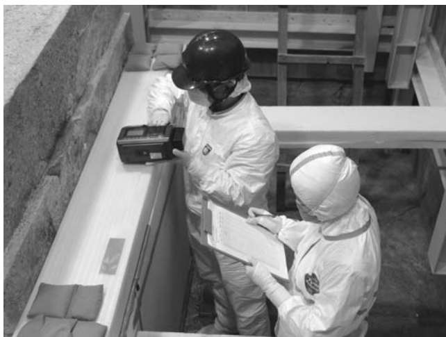
図 3.6 赤外吸光光度計を用いた含水比の調査
