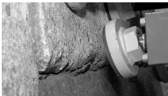
図⑬-5. 最初の地切り直後の状態 (床石 4)
