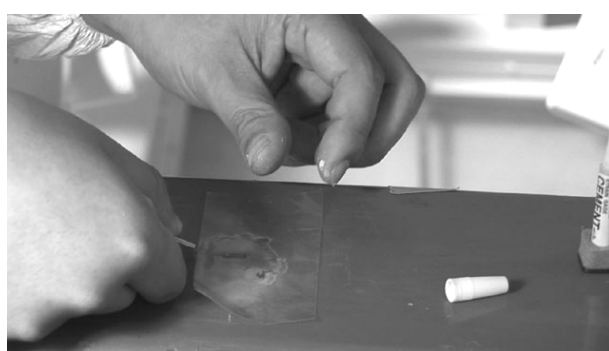
図 4.2 治具にストレインゲージを設置
