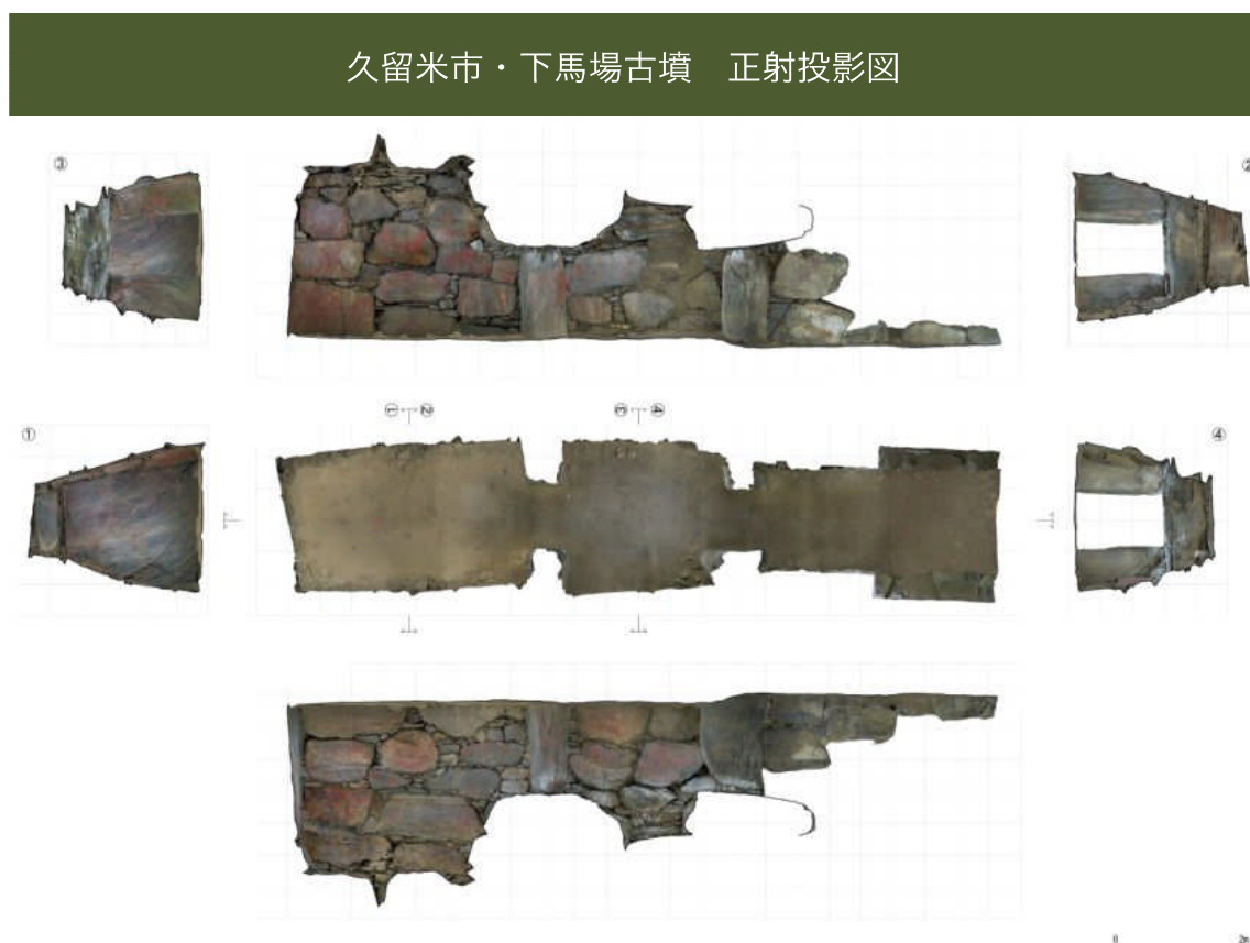
図4 三次元デジタル計測データから作成した古墳内部の図化
