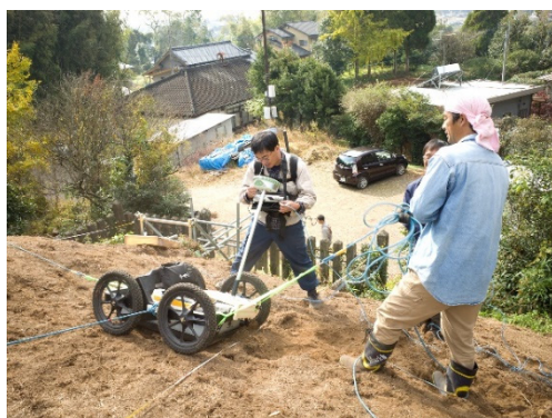
図8 地中レーダー探査の様子と探査結果（奈良文化財研究所提供）
