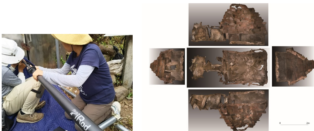
図6 SfM/MVSによる撮影と3次元モデル
