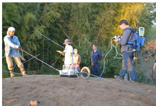
図 2 レーダー探査作業風景
