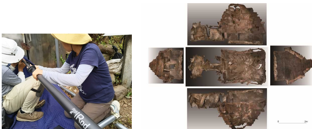
図6 SfM/MVSによる撮影と3次元モデル
