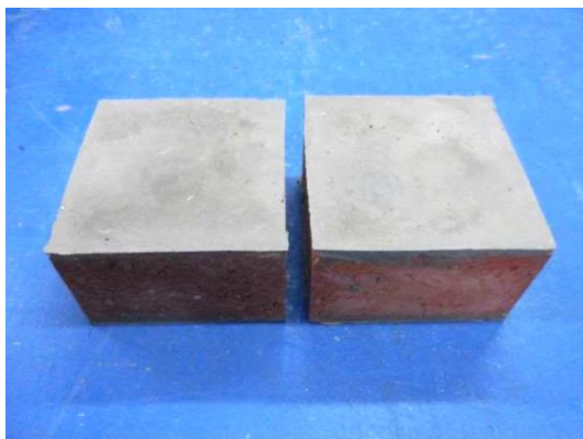
No.6 試験体(断面積 100×100 程度)
