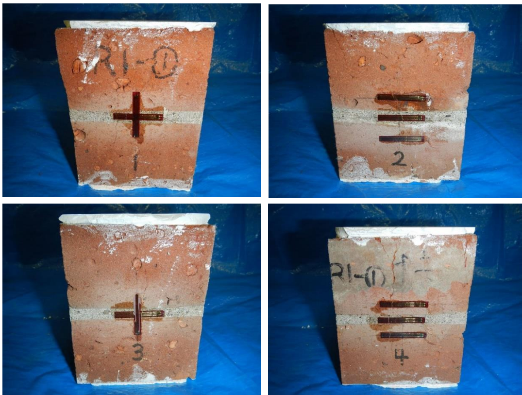
煉瓦要素供試体の破壊状況 R1-①
