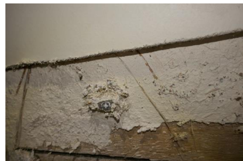
試験体 C2-1 (剥落後ビスの様子)
