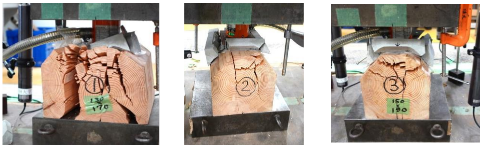
写真 4 各試験体の破損状況：木口面
