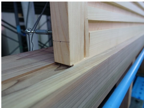
縦框の割裂破壊 (M 試験体)
