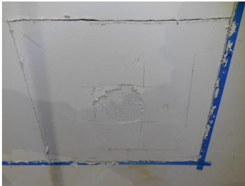
試験体 A2-1 (剥落後)
