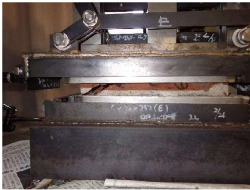
煉瓦単体圧縮強度供試体の破壊状況
