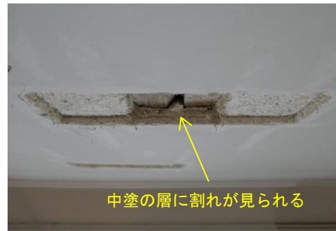
試験体 2（中塗りで剥離後、中塗面にて再試験した後の様子）
