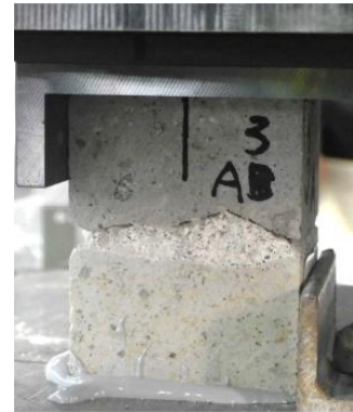
No.6 石材+目地 せん断強度試験 ( 40 \times 40 \times 50 )
