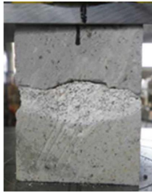
No.2 石材+目地 圧縮強度試験 ( 40 \times 40 \times 50 )
