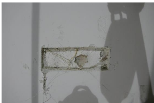
試験体 3（加力後の天井面）
