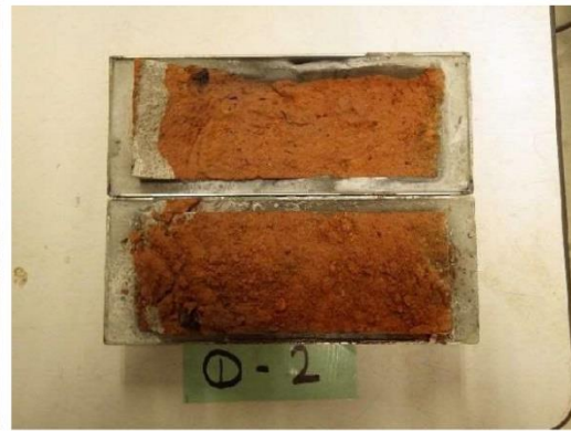
目地引張強度供試体の破壊状況
