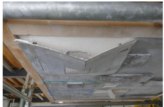
試験体 D1（剥落後ビスの様子）
