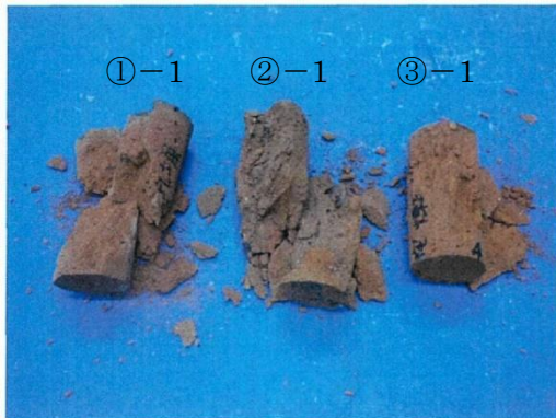
煉瓦単体圧縮強度供試体の破壊状況
