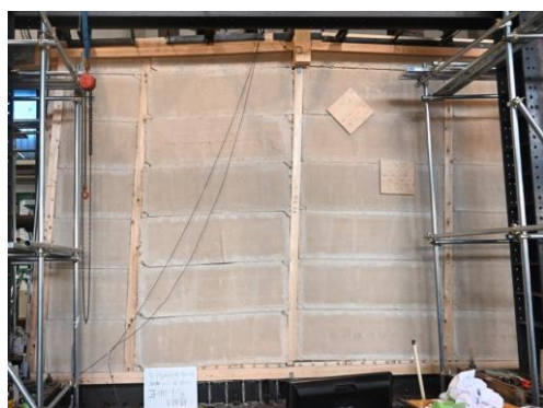
写真 6 破壊の様子 (試験体 6/C-2) / 左: 終局時 / 右: 1/15rad 時中央柱脚浮上り
