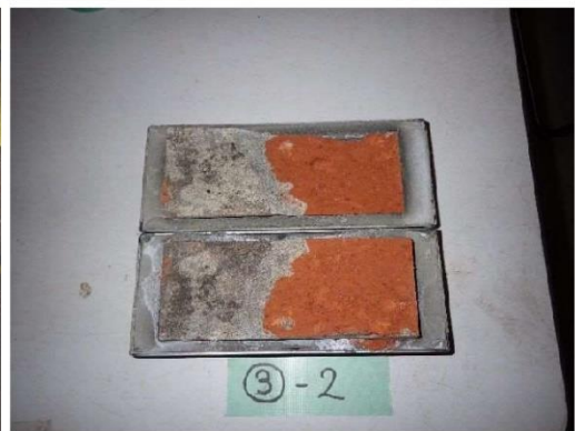
目地せん断強度供試体の破壊状況
