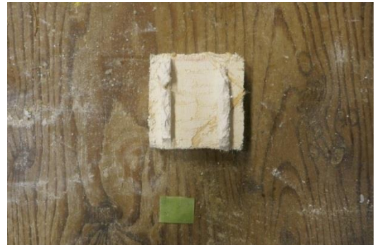
試験体 C3（剥落後鉄板側）
