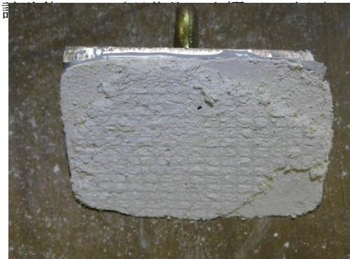
試験体 A2-1 (剥落後鉄板側)
