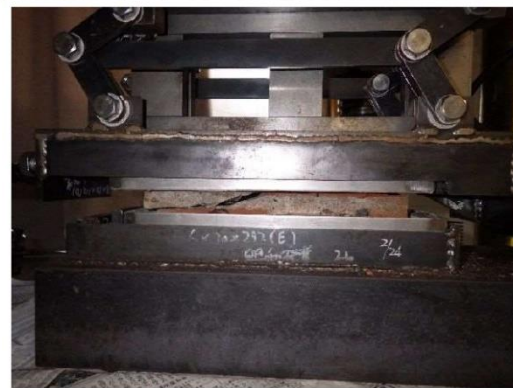
目地せん断強度供試体の破壊状況
