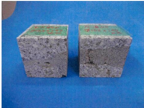
要素圧縮強度試験体 (断面積 70×70 程度)
