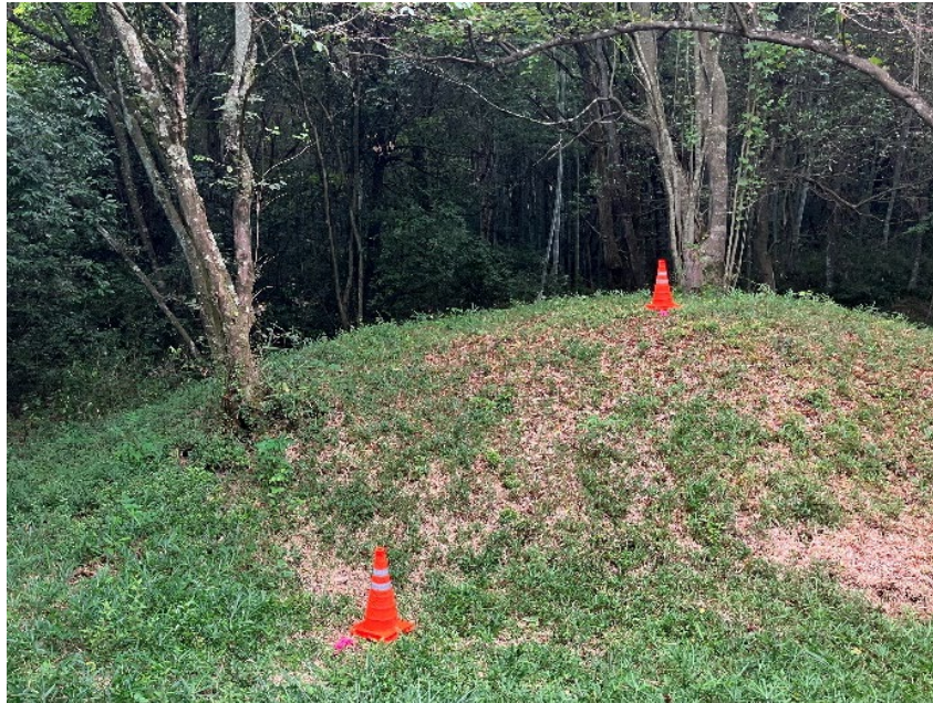
図 2-6-8 座標付与用の現地目標物の例：折り畳みコーン
