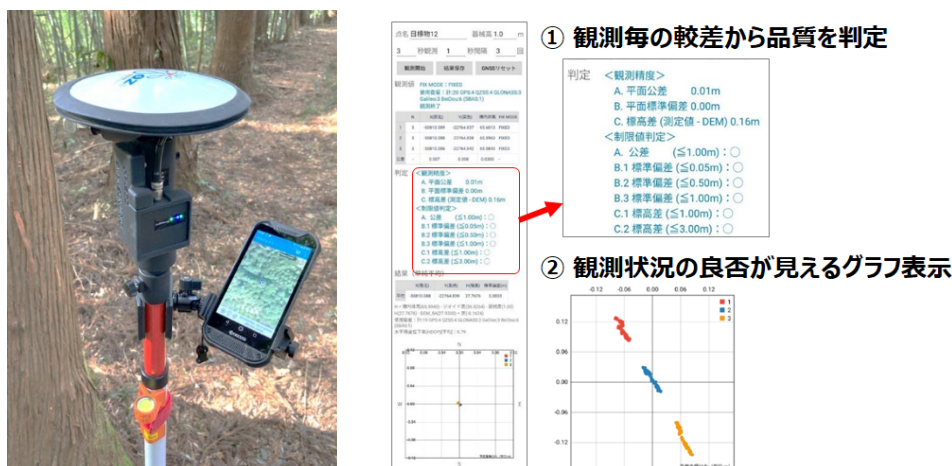
図 2-4-33 SmartSOKURYO POLE による調査情報表示イメージ
