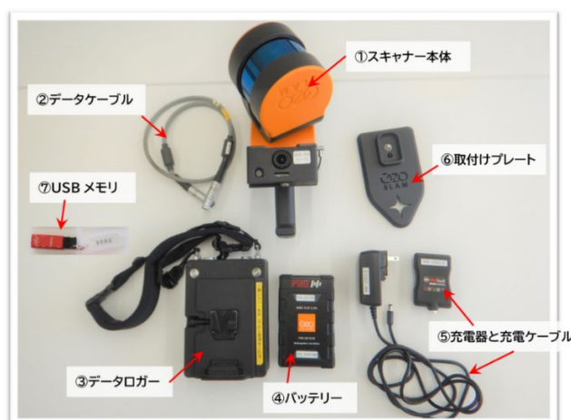
図 2-6-1 手持ちレーザスキャナ (ZEB Horizon の機材一式)
